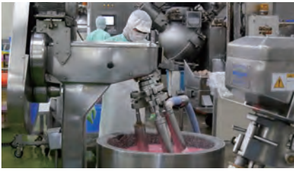
図3 ライカイ攪拌工程
