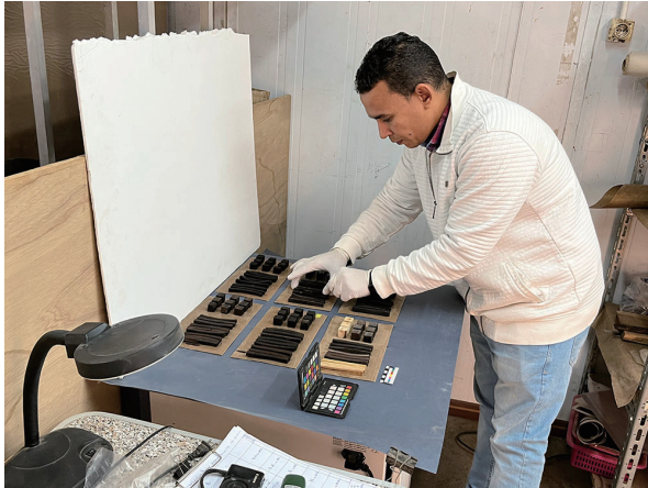
図8 組み立て復原においてさらに部材を強化するための物質を探すためにサンプル木材を準備
