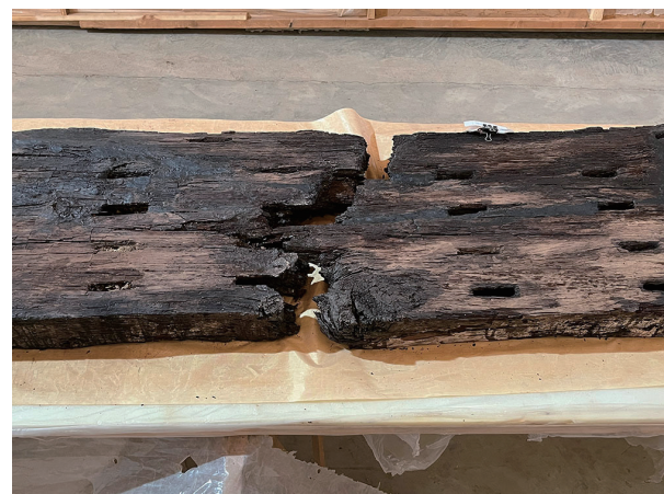
図 14 船の組み立てに備え破損して別々に取り上げられていた部材を接合して復原
