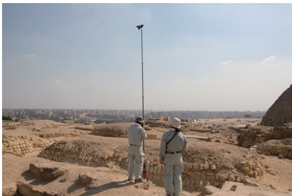
図5 ロッドを用いた高所からの写真撮影
