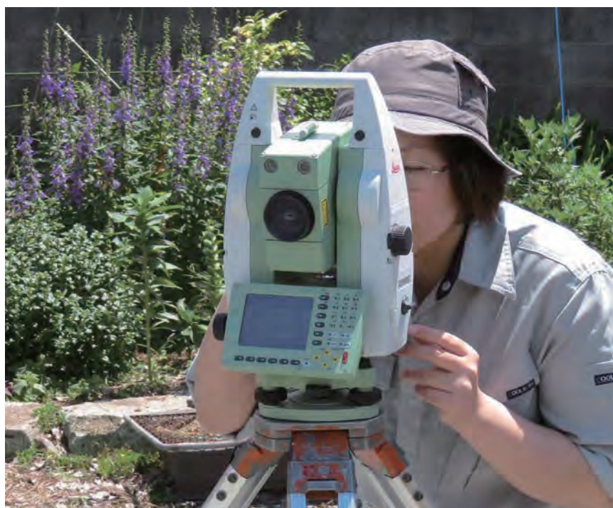
図5 自動追尾トータルステーション (Leica 社製 TCRA1205)
