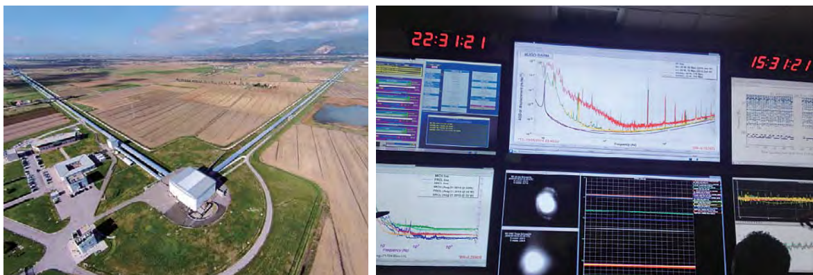
図 28. レーザー干渉計重力波観測所 (LIGO)、左の図は重力波測定用の 2 本の長さ 4 km の真空管を示す。右の図は LIGO によって検出された史上最初の重力波のデータを示す
